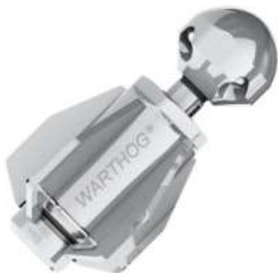
Новая насадка WGP-1 формирует до 40% более мощное тяговое усилие, чем насадка классической конструкции WG-1. Задние форсунки насадки располагаются под более острым углом, а ребра центратора имеют обтекаемую форму. Также дополнительно установлено 2 ребра на центраторе (общее количество ребер — 6).
